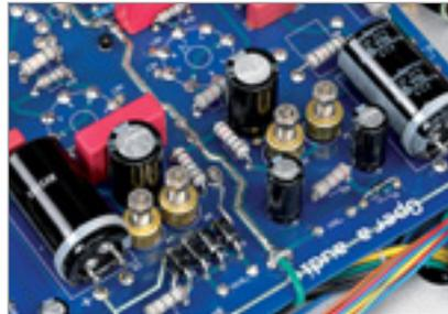
Das Konzept macht separat zu regelnde Gittervorspannungen nötig
