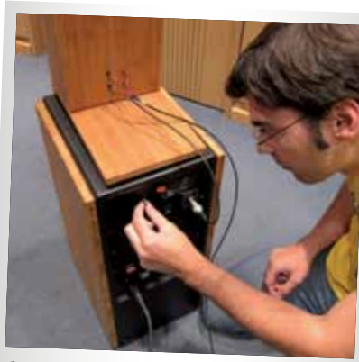
STECKBANK: Eine Brücke aus dem hauchdünnen Dynamikks-Kabel stellt das Signal zum Sub-Eingang durch.
