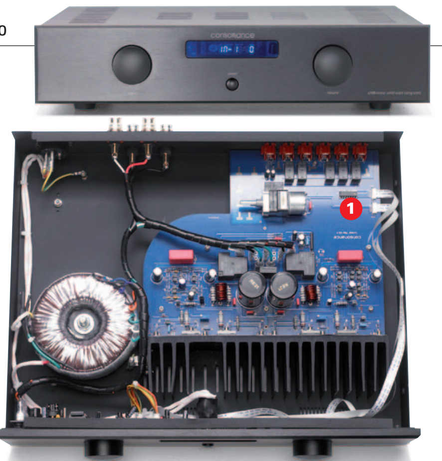
SCHLICHT UND ERGREIFEND: Die schwarzen Kästchen in der Nähe der beiden Elkos beherbergen kernige Ausgangs-Hochstromrelais. Die roten „Wima“-Folienkondensatoren koppeln die von einem IC-FET-Array (1) vorverstärkten Signale an den Endstufen an.
