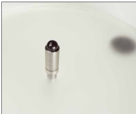
Die Stahlachse mit eingepresster Lagerkugel
